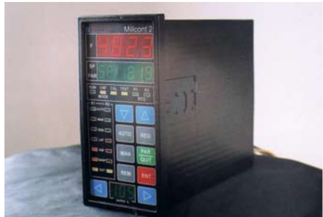
5 MILLCONT 2 Mikroprozessormodul 5 MILLCONT 2 microprocessor module
